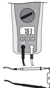
→ Wanneer u een weerstandsmeting uitvoert, moet u erop letten dat de meetpunten waar u de meetstiften mee in contact brengt voor het meten, vrij zijn van vuil, olie, soldeerhars en dergelijke. Dergelijke omstandigheden kunnen het meetresultaat vervalsen.
