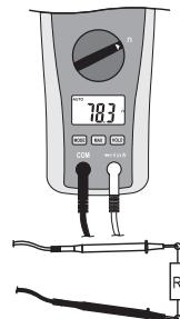
→ Wenn Sie eine Widerstandsmessung durchführen, achten Sie darauf, dass die Messpunkte, welche Sie mit den Messspitzen zum Messen berühren, frei von Schmutz, Öl, Lötack oder ähnlichem sind. Solche Umstände können das Messergebnis verfälschen.
