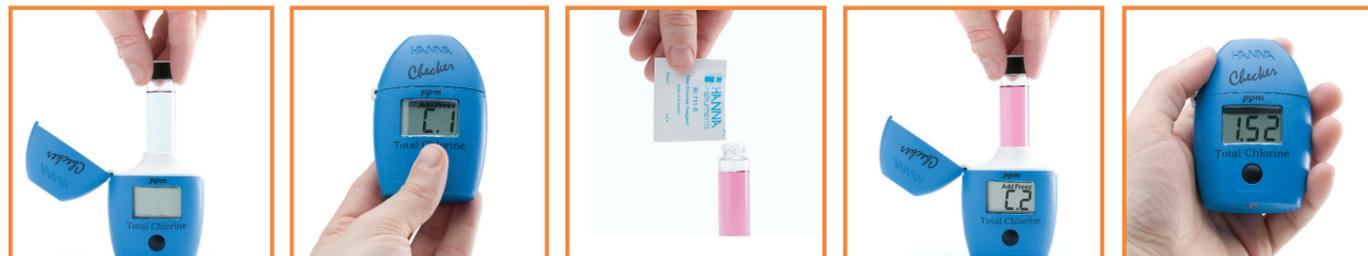
Wasserprobe entnehmen und Küvette in den Checker® einsetzen.
