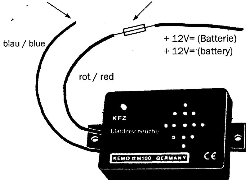
**D** Wenn das Gerät gegen Marder eingesetzt werden soll, dann wird es im Motorraum montiert. Dabei sollte darauf geachtet werden, daß vor der Lautsprecheröffnung des Gerätes möglichst viel Freiraum ist, damit sich die Ultraschalltöne möglichst weitläufig im Motorraum ausbreiten können.
