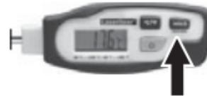
Zur Ermittlung der maximalen bzw. minimalen Temperatur während einer Messung die Taste „Hold“ solange drücken, bis „MAX“ bzw. „MIN“ im Display blinkt. Der normale Messmodus ist eingestellt, wenn keine Funktion im Display blinkt.
