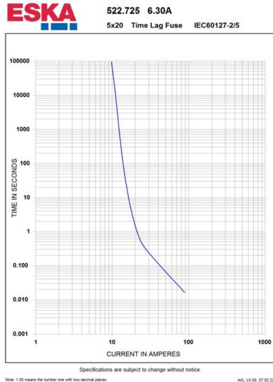
Die Graphen differieren in der unterschiedlich skalierten Stromachse, im linken Fall normiert auf Vielfache des Nennstromes, in der rechten Darstellung mit logarithmischer Einteilung der Stromachse (dient zum Vergleich von unterschiedlichen Stromstufen in einer Grafik).
