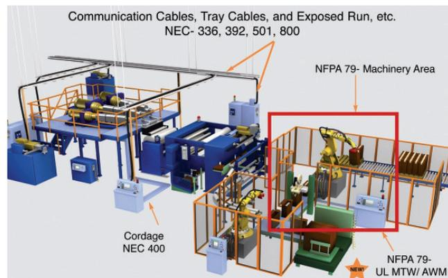
Das Schema einer industriellen Maschine zeigt wesentliche Anwendungen von Kabel und Leitungen mit Verweis auf die zugehörigen Abschnitte in NEC®/NFPA. ‚NEC®‘ ist ein Markenzeichen der National Fire Protection Association <NFPA>.
