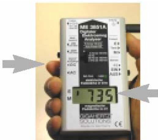
Obr. 15 (správné držení přístroje při měření)
