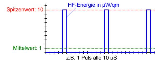
In der Schalterstellung „**Spitzenwert**“ zeigt das Gerät die volle **Leistungsflussdichte** des Pulses an (im Beispiel also 10  $\mu\text{W}/\text{m}^2$ ). In der Schalterstellung „**Mittelwert**“ wird die Leistungsflussdichte des Pulses über die gesamte Periodendauer gemittelt Angezeigt wird also 1  $\mu\text{W}/\text{m}^2$  ( $= ((1 \times 10) + (9 \times 0)) / 10$ ).
