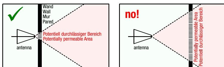
Le type de blindage adapté en fonction du niveau d'atténuation nécessaire en tant que tel doit toujours être défini par un spécialiste professionnel et généralement la surface couverte doit souvent être plus grande que la zone de pénétration du signal.
