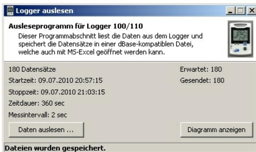
Klicken Sie hierzu auf "Diagramm anzeigen". Danach erscheinen die Daten in einem Fenster des Diagrammbereichs und können weiter bearbeitet werden.
