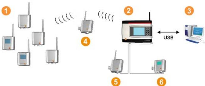
Mit dem Messsystem werden Umgebungs- oder Prozessdaten für Temperatur und Luftfeuchte in geschlossenen Räumen mittels Fühler 1 gemessen und aufgezeichnet. Diese Messwerte werden an die Saveris-Base 2 per Funk übertragen und von dieser gespeichert. Zur Optimierung des Funks kann bei schwierigen baulichen Gegebenheiten ein Router 4 eingesetzt werden. Die Daten werden von einem Computer 3 von der Saveris-Base abgerufen und in eine Datenbank gespeichert.
