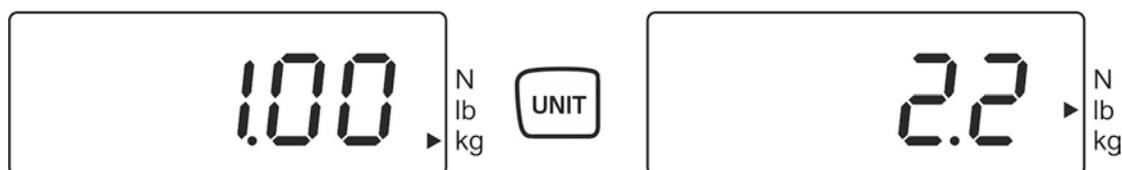
Para cambiar entre las unidades de pesaje **kg**→**lb**→**N** presionar la tecla **UNIT**.
