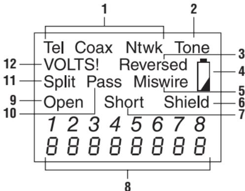
\* El Micro NETcat requiere una batería de 9V de tipo a presión (se recomiendan las baterías alcalinas). Cuando aparece el icono de batería baja, significa que sólo quedan pocas horas de uso normal. La precisión de las mediciones se verá afectada si se utiliza la unidad con una batería baja.
