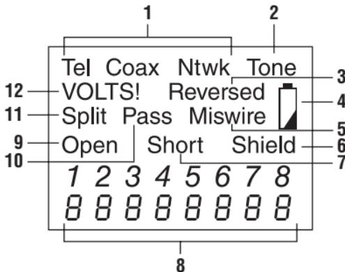
\* Le Micro NETcat exige l'utilisation d'une pile de 9 V de type à encliquer (des piles de type alcalin sont recommandées). Lorsque l'icône de pile faible est affichée, il reste quelques heures d'utilisation normale. L'utilisation de l'appareil lorsque la pile est faible réduira éventuellement la précision des mesures.
